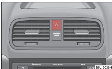
Obr. 42 Přístrojová deska: spínač varovných světel
