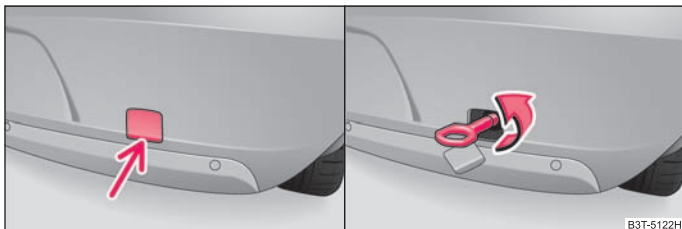
Obr. 204 Zadní nárazník: demontáž krytky / Montáž vlečného oka
