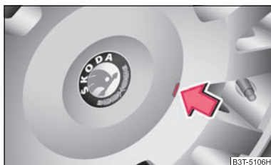
Obr. 197 Stažení ozdobného krytu u kol z lehkých slitin
