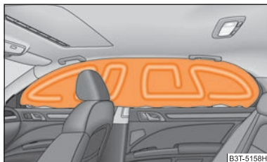
Obr. 160 Hlavový airbag naplněný plynem
