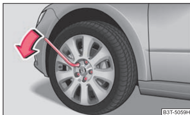
Obr. 198 Výměna kola: povelování šroubů
