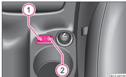
Obr. 27 Střední konzola: spínač centrálního zamykání
