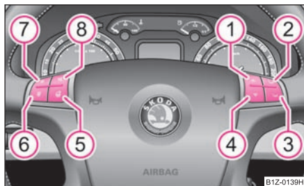
Obr. 149 Multifunkční volant: ovládací tlačítka autorádia
