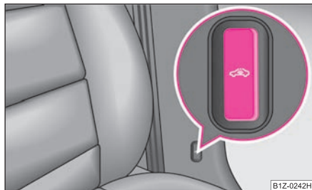
Obr. 33 Tlačítko hlídání vnitřního prostoru
