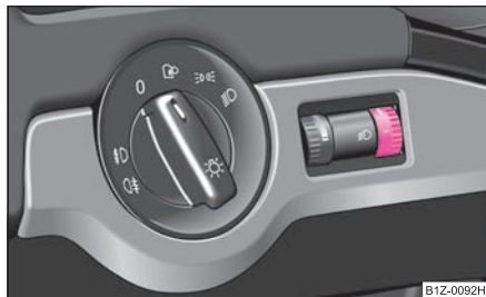
Obr. 43 Přístrojová deska: nastavení sklonu světlometů
