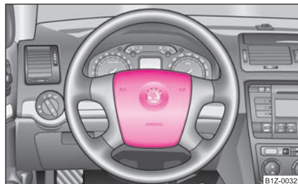
Obr. 164 Airbag řidiče ve volantu
