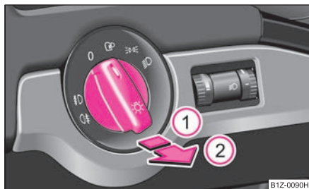
Obr. 39 Přístrojová deska: spínač světel
