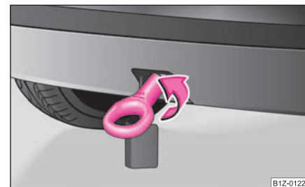
Obr. 221 Zadní nárazník: montáž vlečného oka
