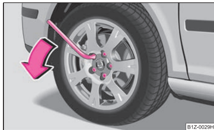
Obr. 214 Výměna kola: povolení šroubů
