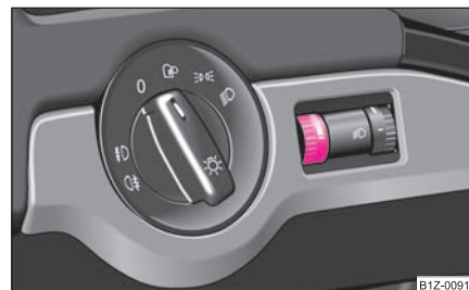
Obr. 42 Přístrojová deska: osvětlení přístrojů
