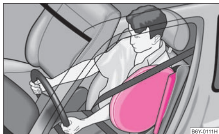
Obr. 169 Plynem nafplněné boční airbagy
