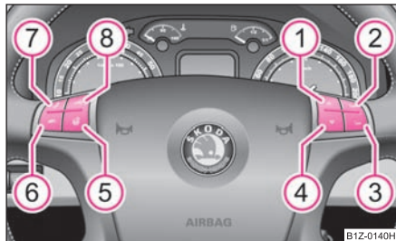
Obr. 150 Multifunkční volant: ovládací tlačítka autorádia a telefonu
