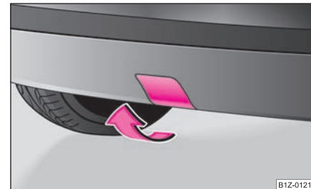
Obr. 220 Zadní nárazník: demontáž krytky
