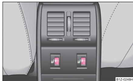
Obr. 71 Středová konzola vzadu: otočný regulátor vyhřívání zadních sedadel
