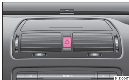
Obr. 44 Přístrojová deska: spínač varovných světel
