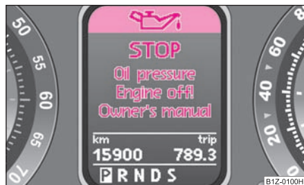
Obr. 16 Informační displej: nízký tlak oleje
