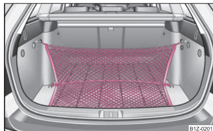
Obr. 77 Upevňovací síť: rozdělení zavazadlového prostoru
