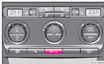
Obr. 186 Spínač nastavení kontrolní hodnoty tlaku v pneumatikách
