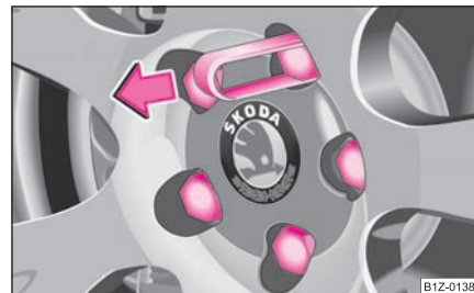
Obr. 212 Stažení krytky šroubu kola
