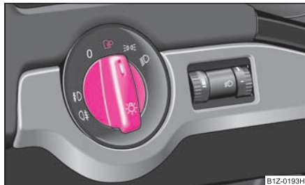
Obr. 40 Přístrojová deska: spínač světel
