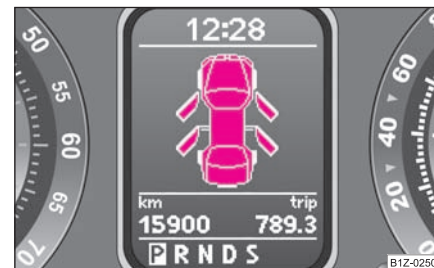
Obr. 13 Informační displej: signalizace otevřených dveří
