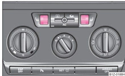
Obr. 70 Přístrojová deska: otočný regulátor vyhřívání předních sedadel
