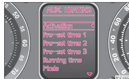
Obr. 128 Informační displej: Aux. Heating (Přídavné topení)
