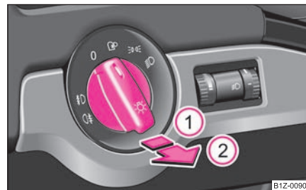
Obr. 41 Přístrojová deska: spínač světel
