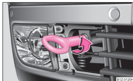
Obr. 219 Přední nárazník: montáž vlečného oka
