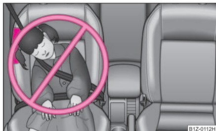
Obr. 175 Nesprávně zajištěné dítě na sedadle v poloze, ve které je ohroženo bočním airbagem
