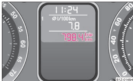
Obr. 3 Displej: počítadlo denní ujeté vzdálenosti
